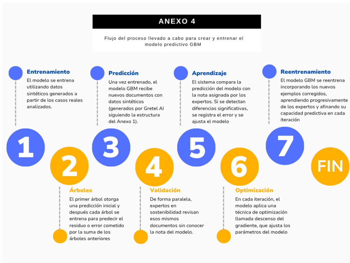
Anexo 4. Esquema del proceso de entrenamiento y ajuste del modelo predictivo GBM a partir de datos sintéticos (desarrollo propio).
